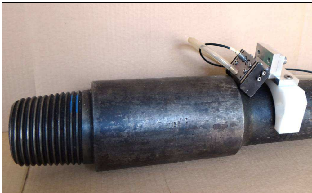
Рисунок 1 –УЗК ниппельной части БТ со стороны 35°- скоса.
