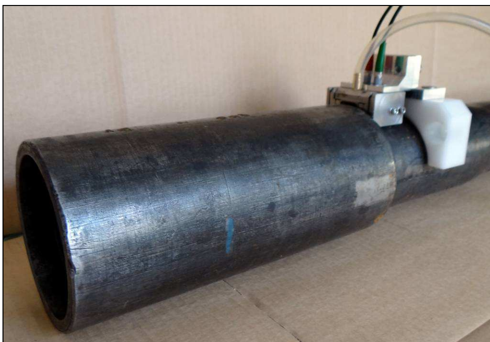
Рисунок 4 –УЗК муфтовой части БТ со стороны прямоугольного упорного уступа.
