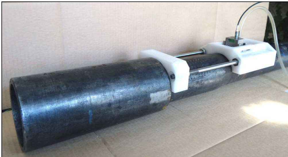
Рисунок 7 – УЗК кольцевого сварного шва бурильной трубы.
